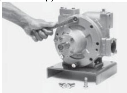
Проверить приводной вал насоса на отсутствие зазубрин и других повреждений, могущих повлечь повреждение уплотняющих О-колец во время снятия боковой крышки. Обе крышки закреплены посредством 2х конических штифтов и оборудованы резьбовым отверстием для облегчения демонтажа крышки. Ввернуть крепежный болт в резьбовое отверстие и удалить конический штифт.
